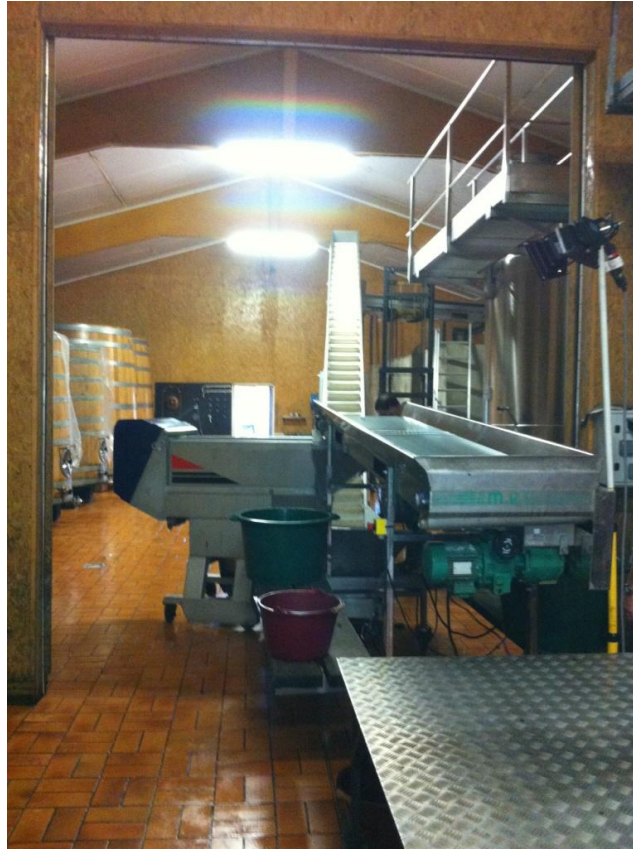
Figuur 5 Opstelling table de tri met égrappoir aan de achterzijde, gevolgd door een lopende band naar het vat
